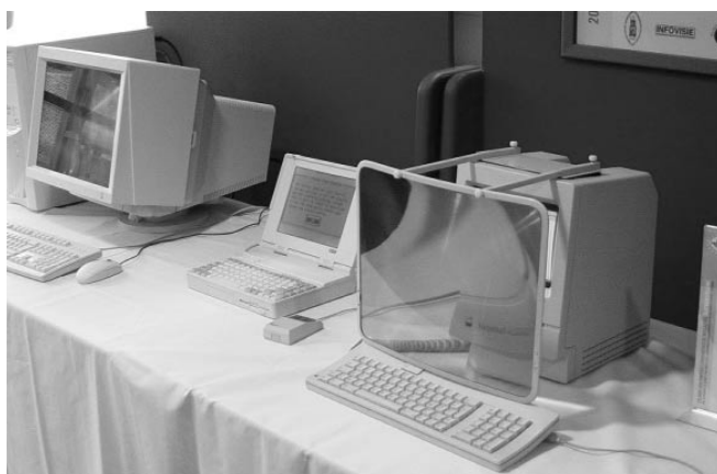
Vorzetscherm met lichtafscherming (links op de foto)
