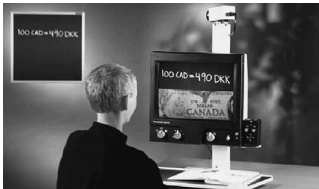
Kleurenbeeldschermloep met bordcamera en split screen mogelijkheid zodat de twee camerabeelden tegelijk getoond worden op het scherm
