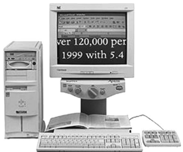
'Klassieke' beeldschermloop met pc-aansluiting waarbij beide beelden in split screen getoond worden
