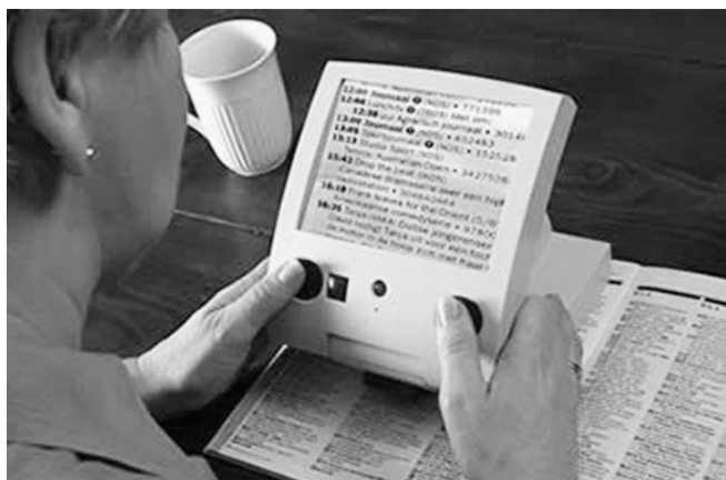
Koffermodel kleurenbeeldschermloep met camera en scherm in één behuizing. De vergroting is traploos instelbaar met twee drukknoppen
