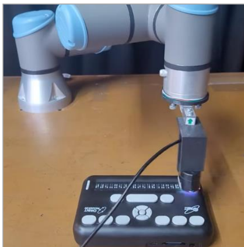
Afbeelding: robotarm leest braille op een kleine leesregel
